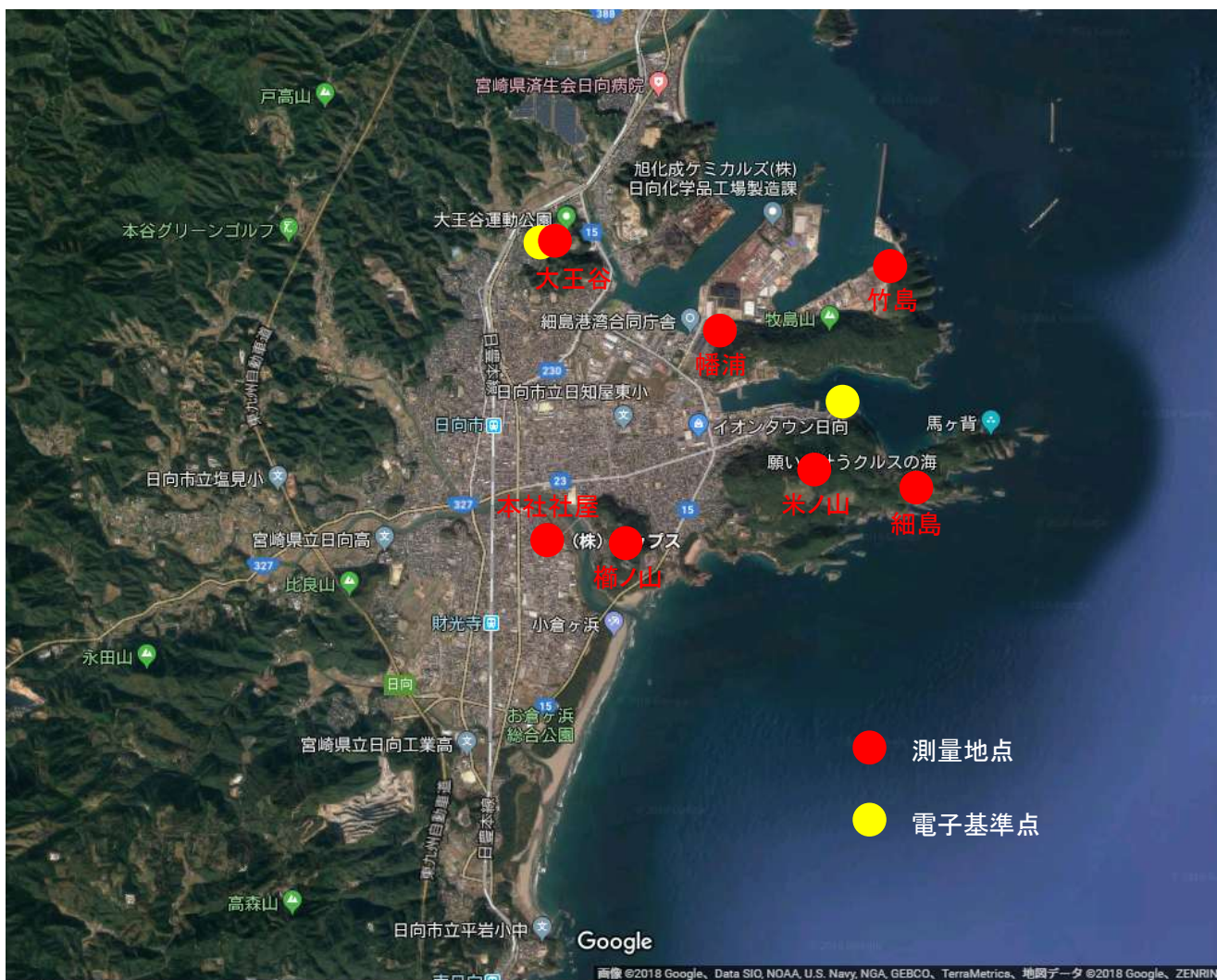
図 測量地点と電子基準点の位置
